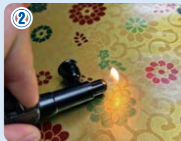
ガラス繊維で作られたマットは燃えないので安心です。
